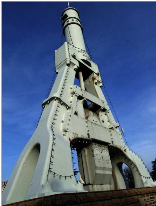
Photographie 24 - Le marteau-pilon à vapeur. Le Creusot. Source : Ecomusée du Creusot-Montceau-les-Mines
